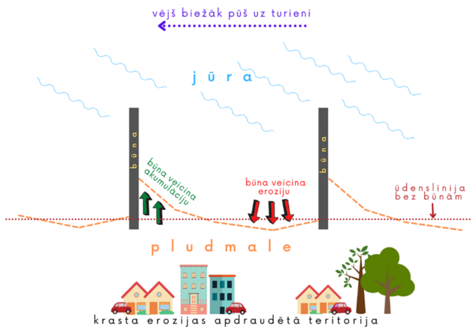
4.7. attēls: Shematiska aktīvo preterozijas būvju (būnu) radītās ietekmes uz krasta eroziju un akumulāciju vizualizācija.
