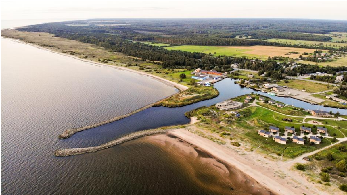
7. attēls. Sanešu garkrasta kustības pārtraukums – Kuivižu ostas moli un tā radītās pastiprinātas akumulācijas (dienvidu pusē) un pastiprinātas erozijas (ziemeļu pusē) zonas.
